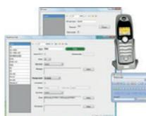
Application client couplage téléphone numérique (VoIP) - Permet de diffuser des appels téléphoniques dans un système Praesideo - En fonction de l'autocom, il peut être nécessaire d'utiliser un routeur d'appel VoIP de type Cisco Linksys SPA3102 - Menu didacticiel audio pour déclencher un appel - Gestion utilisateurs avec contrôle d'accès - Possibilité de sélectionner une/des zones, carillons, messages, macro - Compatible avec les logiciels de téléphonie SIP type X-Lite
